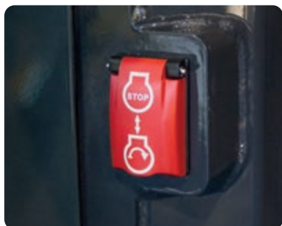
Noodstop-schakelaar voor de motor
