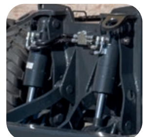
Blad- en stempelpootcilinders met ingebouwde terugslagklep (standaard)
